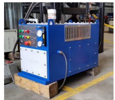
2. Unidad Hidráulica De Potencia.
